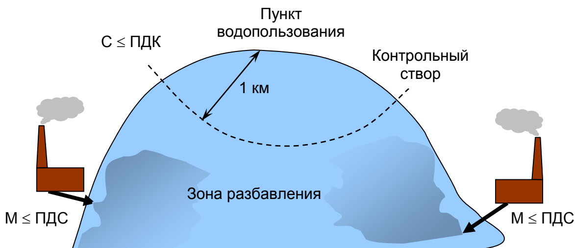
Рис. 4.13. Схема определения ПДС в непроточные водоёмы
